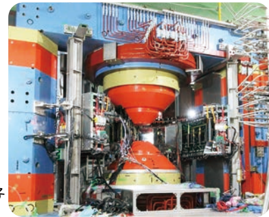
φ中間子の重さを測る大型電磁石
