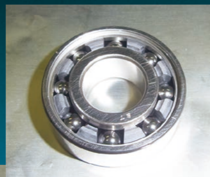
回転標的用に開発されたベアリング。固定潤滑剤として二硫化タングステンブロックが使用されている。
