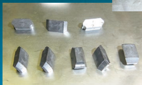
回転標的用に開発されたベアリング。固定潤滑剤として二硫化タングステンブロックが使用されている。
