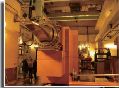
中性子生成標的 中性子を発生させるための標的台車。台車内で標的の水銀が循環し放熱する仕組みです。
