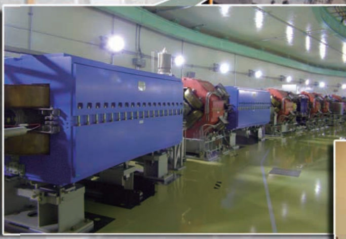
3GeV 陽子シンクロトロン 線形加速器から送り込まれる陽子を加速するための電磁石がリング状にずらりと並ぶ陽子シンクロトロン。 陽子を30億電子ボルト(光速の約97%)まで加速します。
