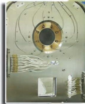
ミュオン生成標的 陽子を衝突させミュオンのもととなるπ中間子を発生させるための標的。黒鉛でできた標的の周囲を放熱のための銅で囲ってあります。
