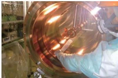
空洞内壁の洗浄の様子 (リニアック)
