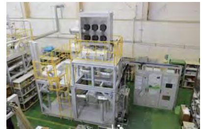
液体鉛ビスマス共晶合金による 構造材腐食特性試験用大型ループが完成 (高温工学試験棟)
