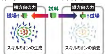
試料へ力を加えた時の、磁気渦(スキルミオン)の生成と消去概念図
