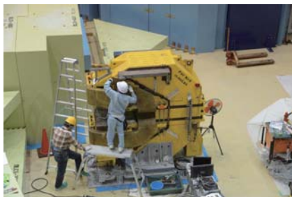
ミュオン実験エリアでの電磁石整備 (MLF第1実験ホール・北側)
