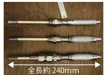
国産化に成功した酸素濃度センサーの外観写真
