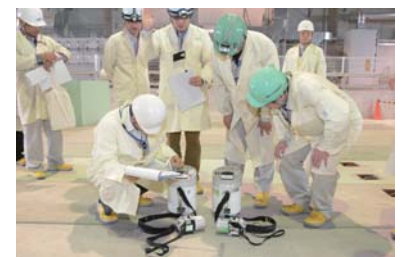
一次ビームライン室上部遮蔽体表面の放射線量測定の様子
