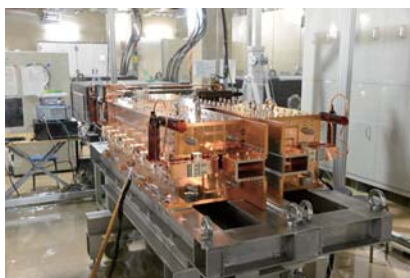
性能試験中のセパラム電磁石 (MR第3電源棟)
