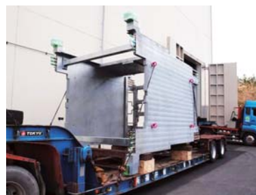
電磁ホーン予備機の専用吊り具が、ターゲットステーション建家に搬入 (ニュートリノ実験施設、1/30)
