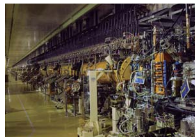
リニアックは加速管転倒などの大きな被害はなし。仮設電源によりトンネル内の排水を3/25以降随時実施。仮設の除湿器を持ち込み、除湿開始。（4/11）
