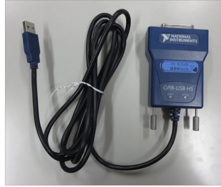
USB-GPIBコネクタの一例
