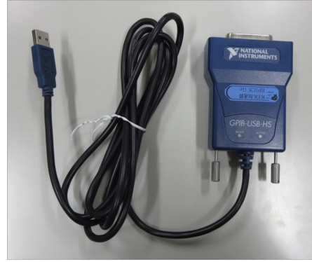
USB-GPIBコネクタの一例
