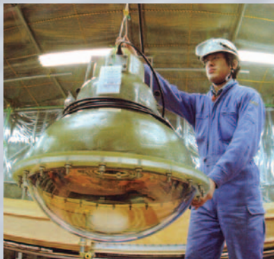
スーパーカミオカンデで使用されている光電子増倍管。世界最大、直径約50cm。
